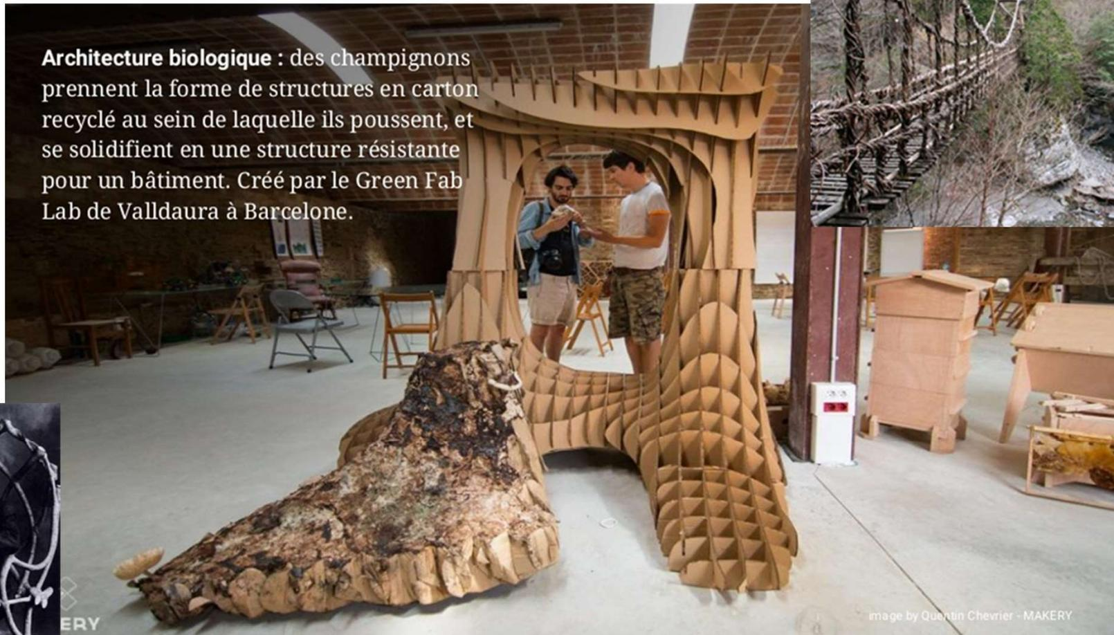
**Architecture biologique** : des champignons prennent la forme de structures en carton recyclé au sein de laquelle ils poussent, et se solidifient en une structure résistante pour un bâtiment. Créé par le Green Fab Lab de Valldaura à Barcelone.
