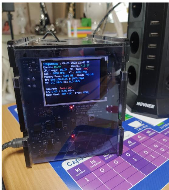
FIGURE 6.5 – Passerelle réseau installée à proximité des capteurs
