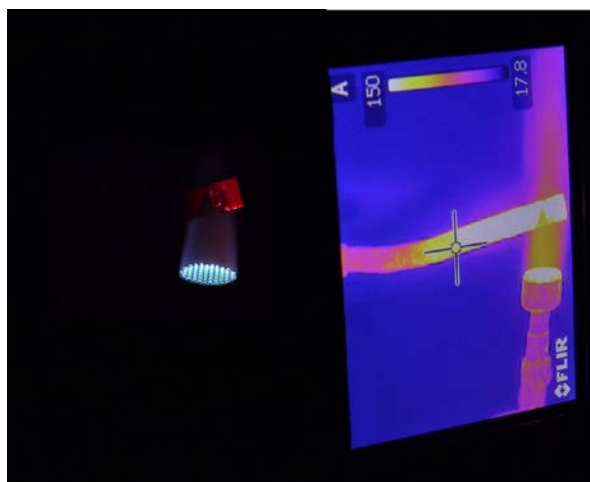
Figure 2 : morceau de cuivre chauffé par un réchaud à gaz (à gauche), observé avec une caméra infrarouge (écran à droite), attribuant une couleur (arbitraire) à une valeur de puissance de rayonnement infrarouge.
