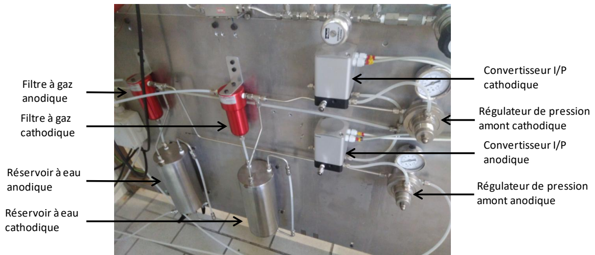
Figure 3.7 : Photos des éléments permettant le contrôle de la pression dans les lignes anodique et cathodique de la pile.
