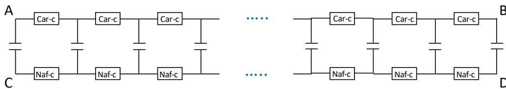
Figure 4.16 : Schéma électrique d'une couche carbone/Nafion®. Car-c représente la résistance électrique du carbone dans la couche et Naf-C la résistance ionique du Nafion®.
