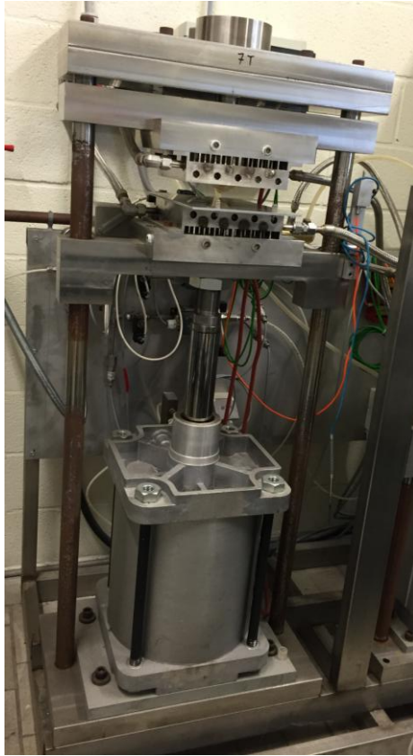
Figure 2.29 : Photo de la presse pneumatique (55 kN).
