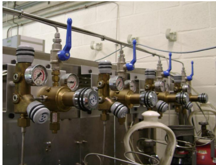
Figure 3.1 : Face arrière du banc de caractérisation PEMFC, composée des bouteilles de gaz et des détendeurs. De gauche à droite : oxygène, air, azote et hydrogène.
