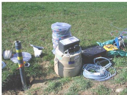
Photo 2. Dispositifs de pompage et d'échantillonnage au PZ E3
