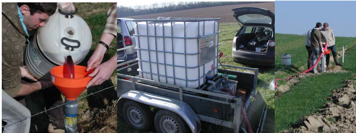
Photo 4. Injection du traceur dans la nappe
