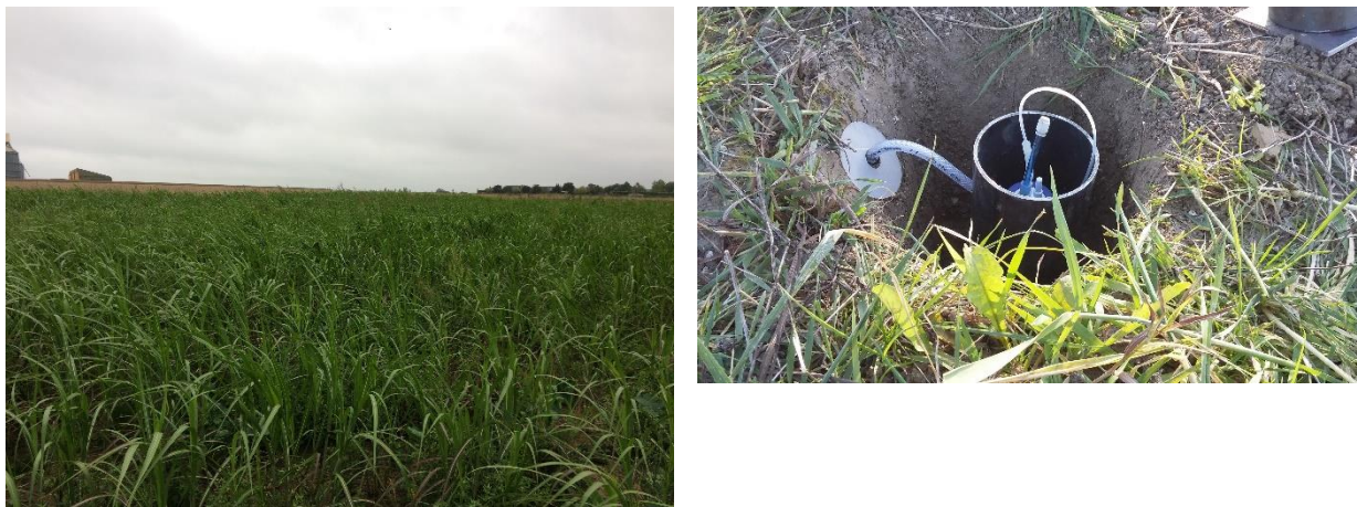
Figure 3. Photo de la plateforme de miscanthus (A) et de l'installation d'une bougie poreuse (B).
