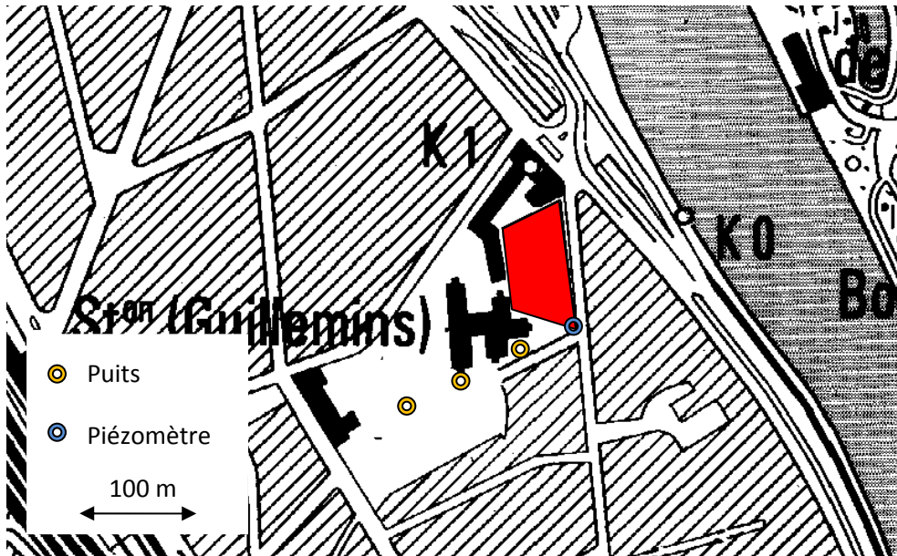
Figure 65: Localisation des 3 puits et du piézomètre destinés aux essais de pompage
