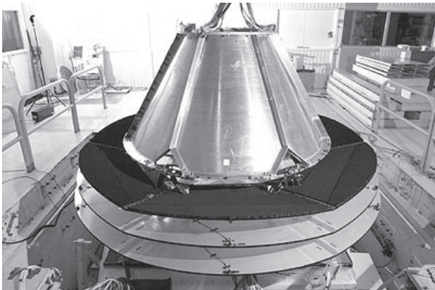
Les écrans de protection thermique en essai
