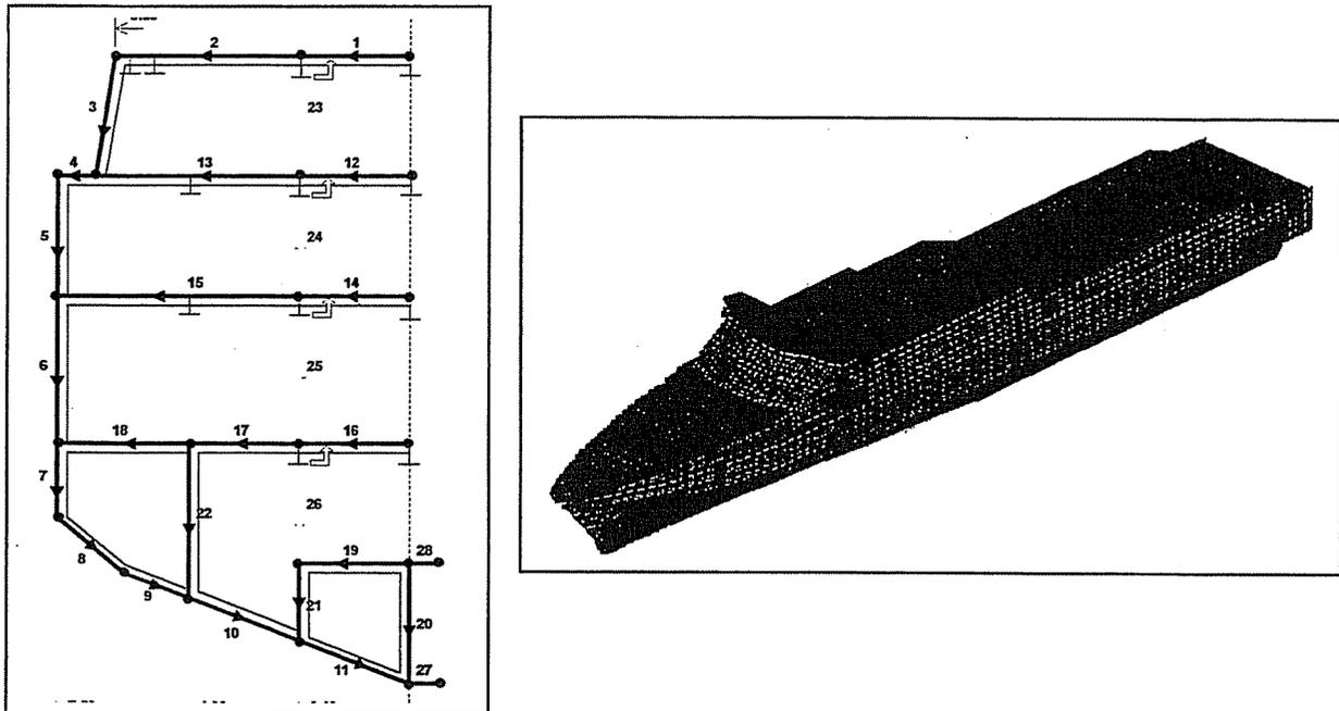
Figure 4-3 : LBR-5 Mesh model of a fast ferry (Corsaire)
