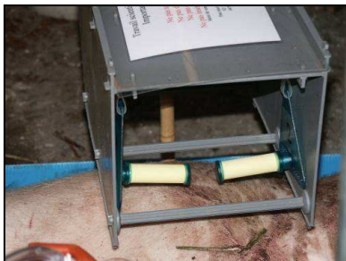
Figure 24. Abri Radiello contenant deux échantillonneurs, PIG-U-1.
