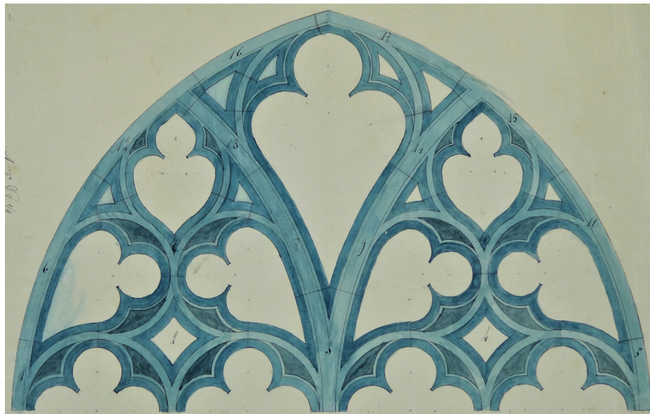
FIG. 2A – Plan pour la restauration du remplage d'une des fenêtres de l'église, avec indication des différents blocs à employer. Date inconnue. © Auteur, archives de la CRMSF.
