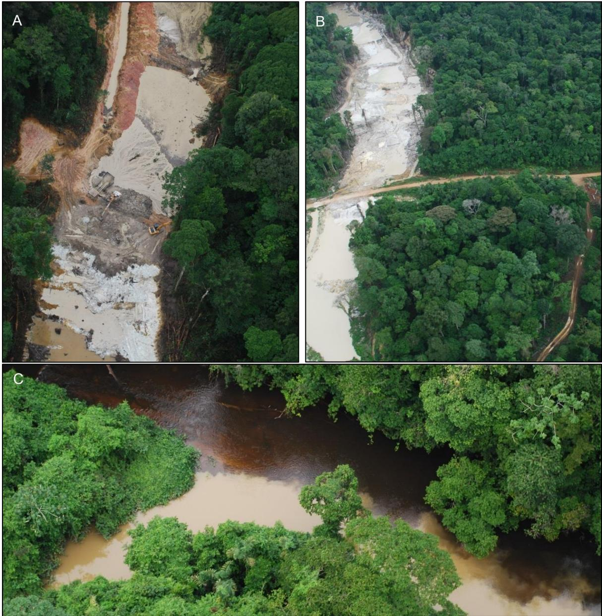
Figure 17 : Impacts directs et indirects de l'activité d'orpaillage avec A. Destruction du lit du cours d'eau et du corridor riverain ; B. Mise en place des voies de communication pour l'accès au site ; C. Panache turbide liée à l'activité minière sur un site à l'amont (DEAL Guyane)
