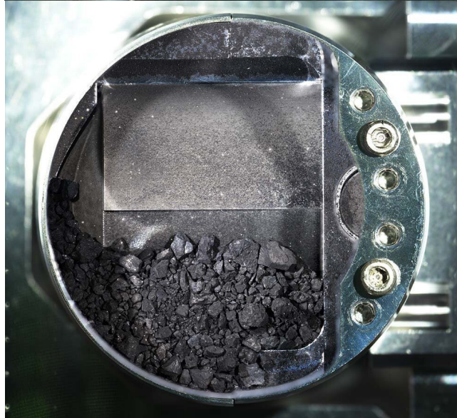
Échantillons de sol de Ryugu provenant du second contact, vus à l'intérieur du compartiment de la capsule rapportée par Hayabusa2. (JAXA)
