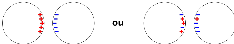
FIGURE 1.4 – On pourrait imaginer que chaque particule se charge soit positivement, soit négativement [16, 17]. Toutefois, il est également possible que chaque grain se compose d’un ensemble de charges différentes, elles-mêmes réparties sur sa surface. Des études récentes montrent que cette dernière supposition donne de bons résultats pour modéliser les interactions d’origine électrique [15].
