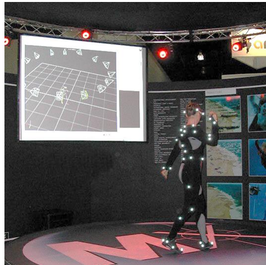
Danseur portant une combinaison avec des marqueurs passifs réfléchissants lors d'une capture optique de mouvement 3D 1
