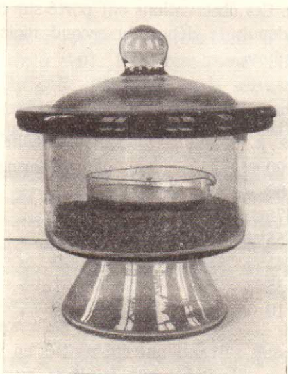
FIG. 1. — Hygrostat pour l'élevage des larves à l'humidité constante de 55% H. R. (le récipient central contient une solution sursaturée de \text{Ca}(\text{NO}_3)_2 ).
