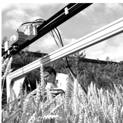
Figure 10.24 – Plateforme de mesure d'imagerie hyperspectrale de terrain.
