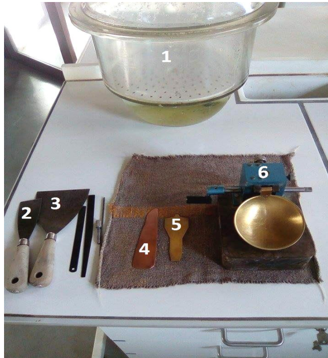
Fig. I.32. Equipements utilisés pour l'essai des limites d'Atterberg. (1 : Dessiccateur ; 2 et 3 : Truelles ; 4 : Spatule ; 5 : outil à rainurer ; 6 : Appareil de Casagrande) (Laboratoire ArGenco, Liège).
