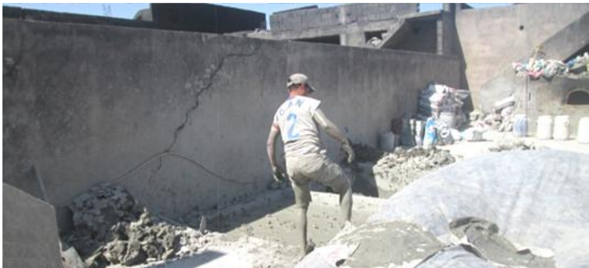
Fig. I.29. Pétrissage de la pâte argileuse dans le bassin de décantation à Benjlikh (photo prise à Fès en 2017).
