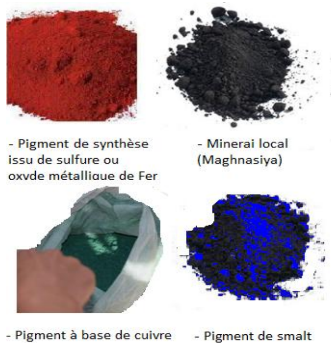
Fig. III.20. Pigments de glaçure utilisés dans le site de Fès (Pigments d'oxyde fer rouge et noir, l'oxyde de cuivre vert et l'oxyde de cobalt bleu).
