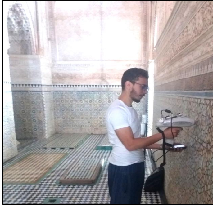
Fig. I.30. Analyse XRF portable in situ sur le zellige des tombeaux Saadiens.
