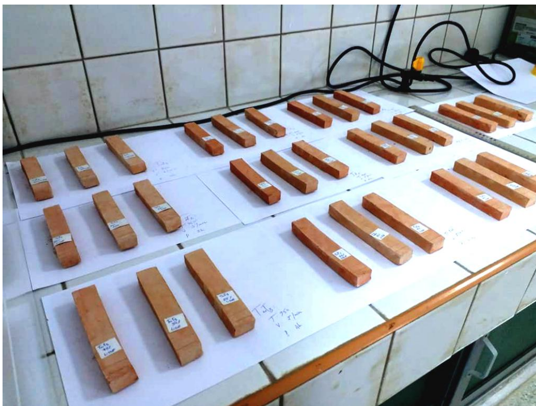
Fig. III.21. Changement de la couleur des briquettes après cuisson pour chaque test.
