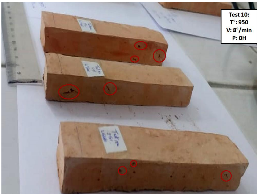
Fig. III.22. Exemples de fentes sur les briquettes (2 x 2 x 10 cm) qui ont subi un cycle de cuisson trop rapide et sans palier.
