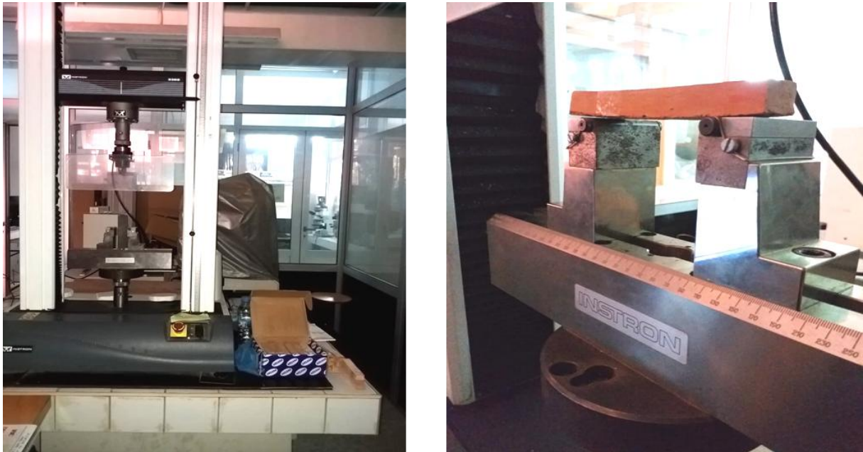
Fig. I.35. Equipement utilisés dans les analyses mécaniques pour déterminer la qualité des briquettes en fonction du cycle de cuisson.
