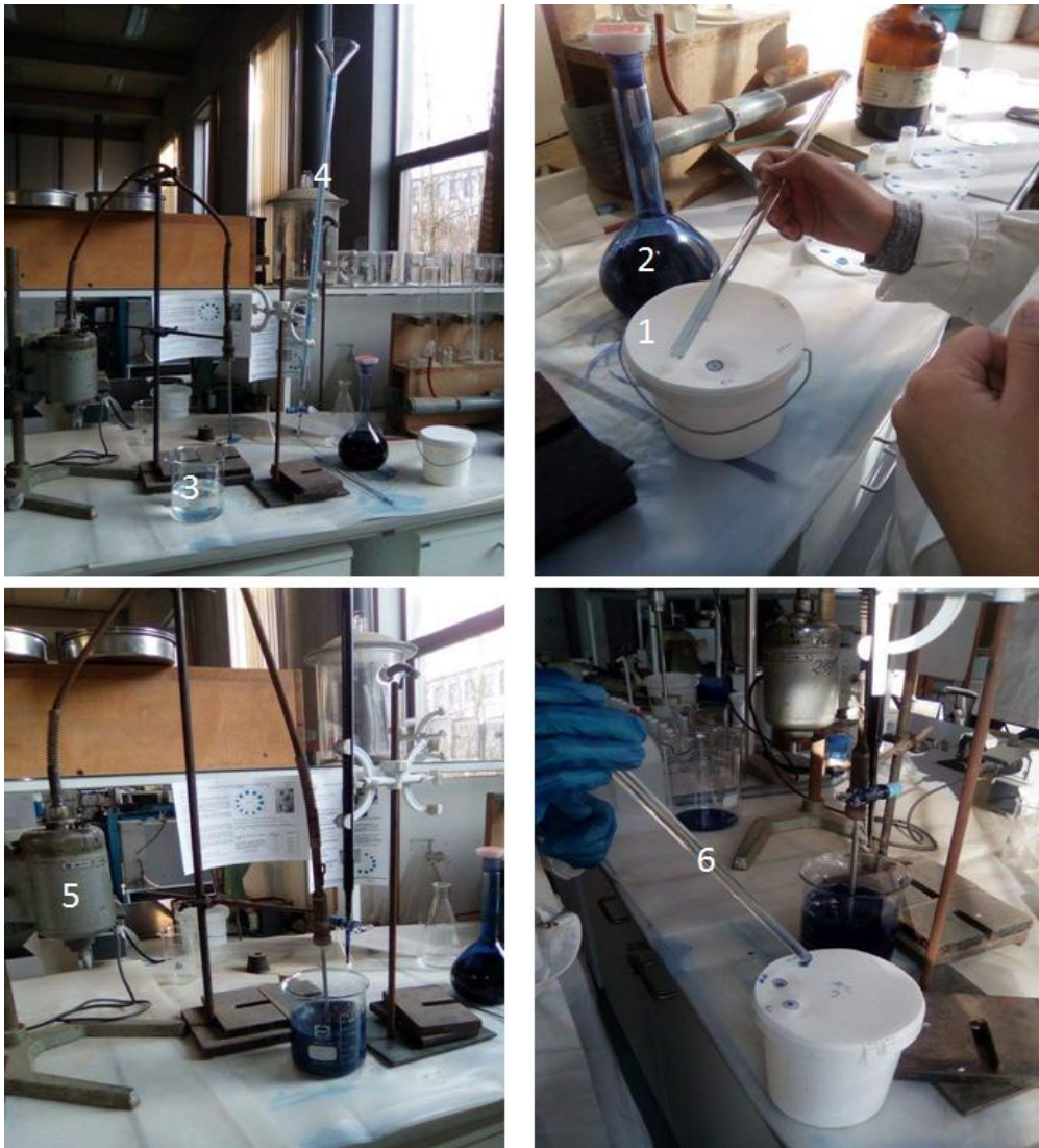
Fig. I.31. Equipements utilisés dans l'essai du VBS. (1 : Papier filtre ; 2 : Bleu de méthylène ; 3 : Bêcher rempli d'eau distillée ; 4 : Burette ; 5 : agitateur à ailettes ; 6 : Tige en verre) (Laboratoire ArGenco, Liège).
