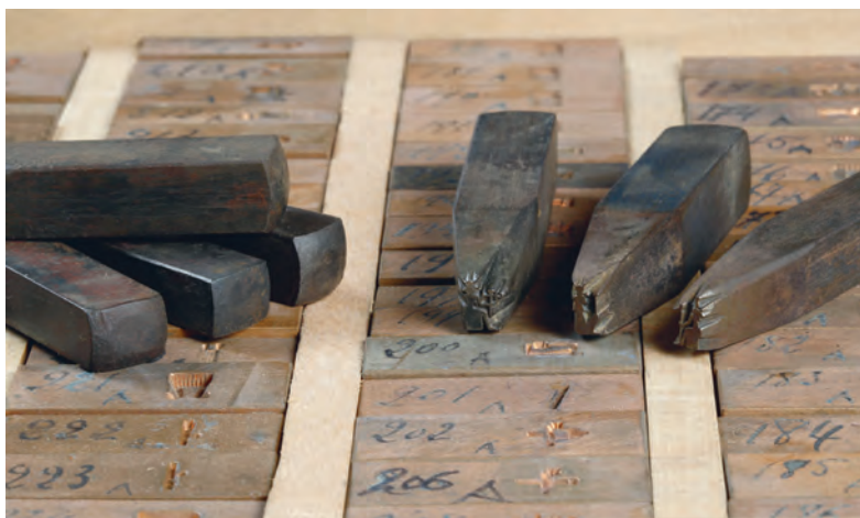
■ Fig. 98. Poinçons et matrices de la police Ifao. © Ifao, nu_2020_05087.
