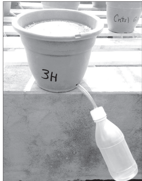
Figura 1. Maceta adaptada para la recolección de lixiviado
