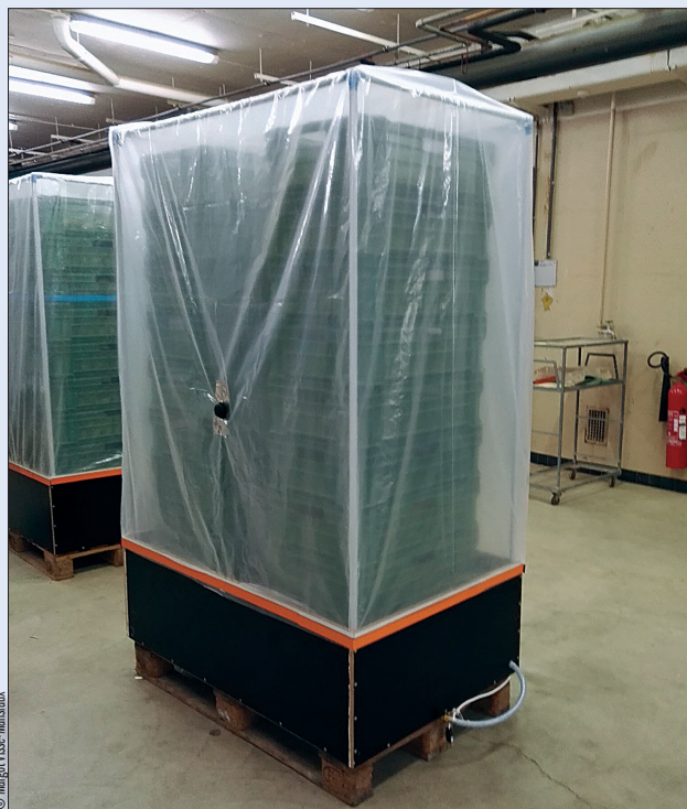
Unité expérimentale automatisée permettant le stockage de 200 kg de pommes de terre.
