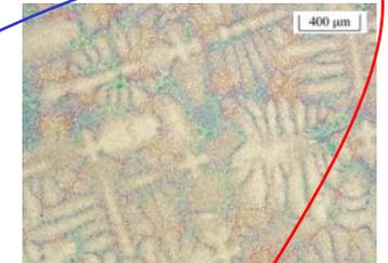
Vues générales de la microstructure dendritique héritée de la solidification à la base (gauche) et dans l'aube (droite)
