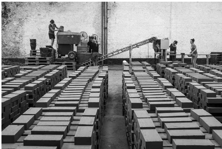
Fig. 1 Fabrication de 19.000 blocs de terre comprimée à partir d'argile de Boom pour la construction d'une classe d'éducation à l'environnement – BC Architects & Studios – Regional House Edegem (BE).
