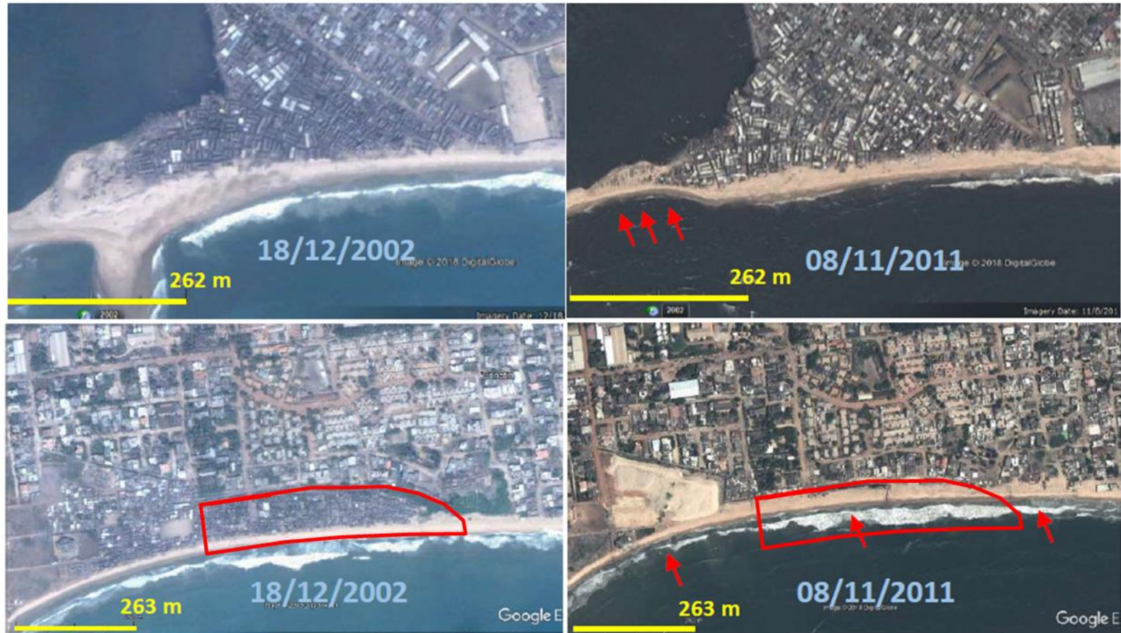
Figure 12: Image des variations de la position du trait de côte entre 2002 et 2013 au niveau des secteurs d'enquête 1 et 3.
