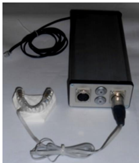
Figure 32 : Processeur qui convertit les données de la gouttière à l'ordinateur (Vandendyck, 2013)
