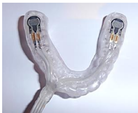
Figure 30 : Prototype de la première gouttière de mesure de pression via capteurs électroniques. (Vandendyck, 2013)
