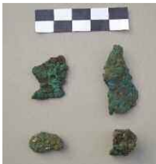
fig. 28. Scorie metallurgiche rinvenute negli strati di riempimento della fossa di fusione.
