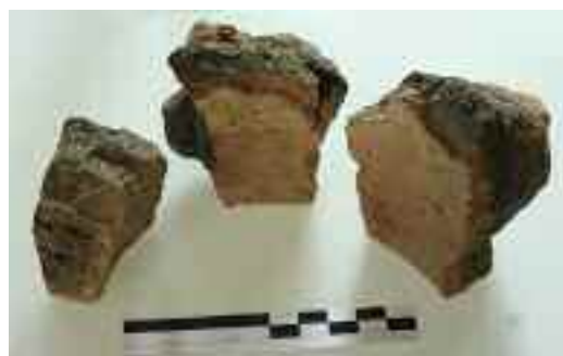
fig. 30. Frammenti di tonaca di campana con diametro di circa 20 cm.
