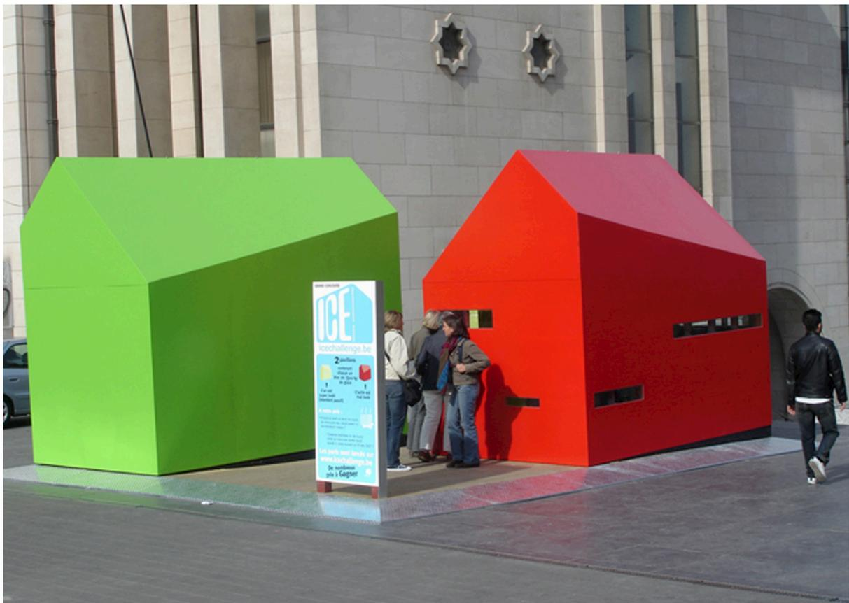
Deux blocs de glace, de 1.300kg chacun, ont été entreposés durant 44 jours dans un pavillon rouge non isolé et dans un pavillon vert isolé selon les standards passifs. L'opération visait à comparer le temps de fonte des deux blocs de glace et, ainsi, à rendre plus concret l'intérêt de la haute efficacité énergétique des bâtiments.
