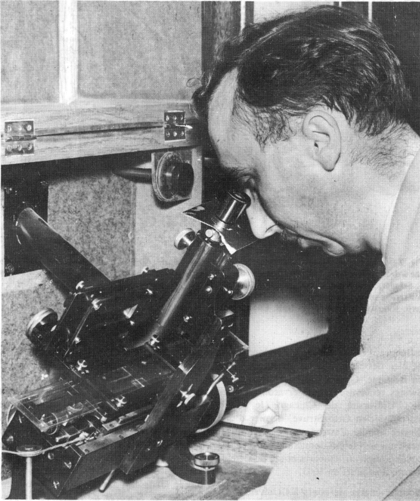
Fig. 1 : P. Swings, dans les années trente, en train de mesurer une plaque spectroscopique à l'aide d'un comparateur.
