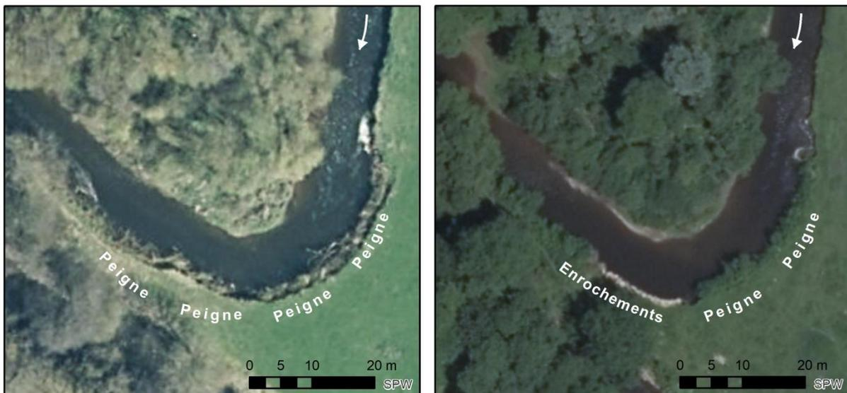
Figure 2.3 : Exemple d'utilisation des orthophotos pour identifier la période durant laquelle un ouvrage de protection de berges a été détruit. Le peigne mis en place sur la Rulles à Ansart semble en bon état en 2015 (orthophoto de gauche). Le recul de la berge et la présence d'enrochements sur l'orthophoto de 2018 indiquent que le peigne a été partiellement détruit.
