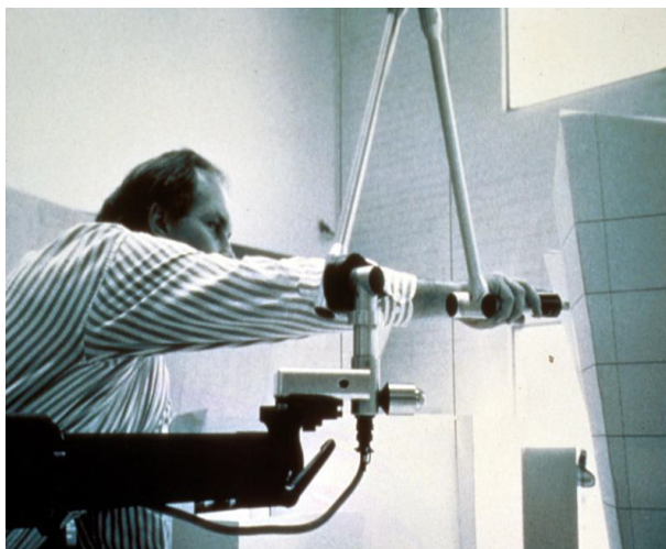
Figure 32: Numérisation de points d'une maquette physique au moyen d'un bras articulé, image publiée dans (Smith 2005, p.50)
