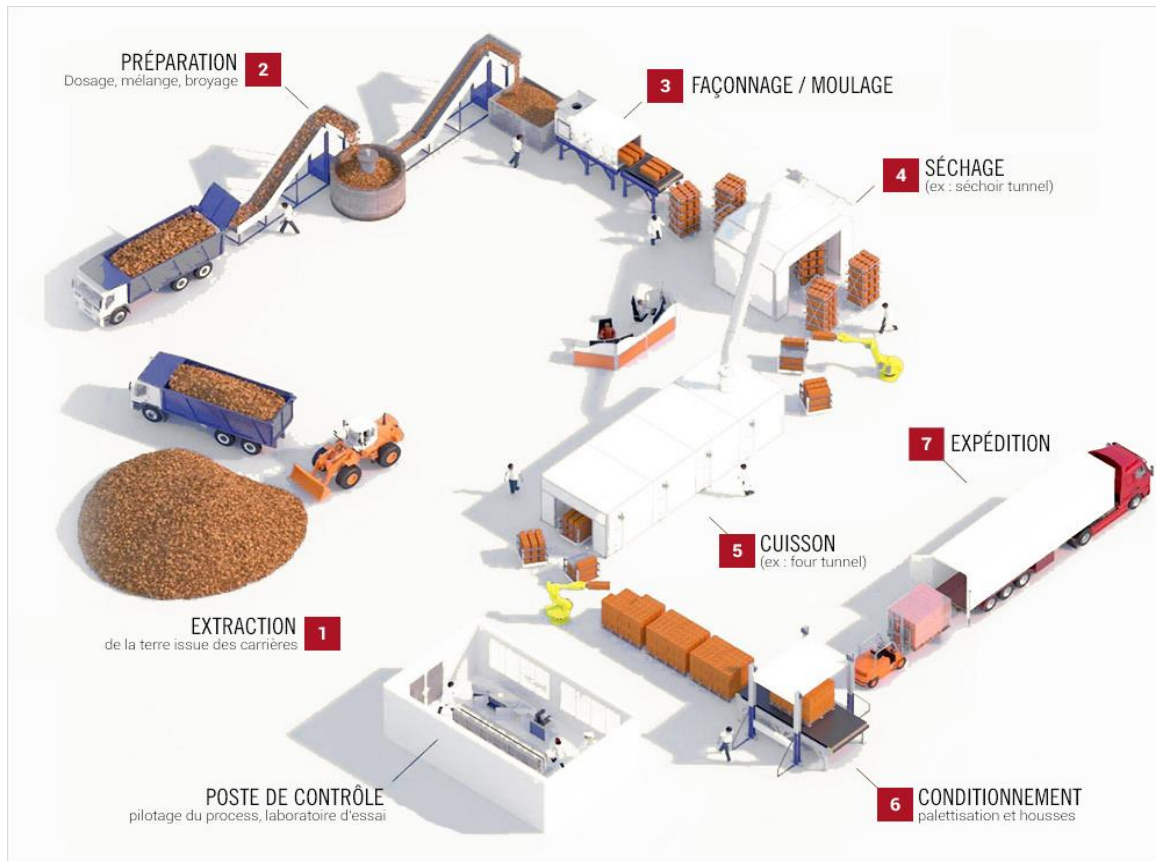
Figure I-2 Schéma de fabrication des briques (Brique.org).
