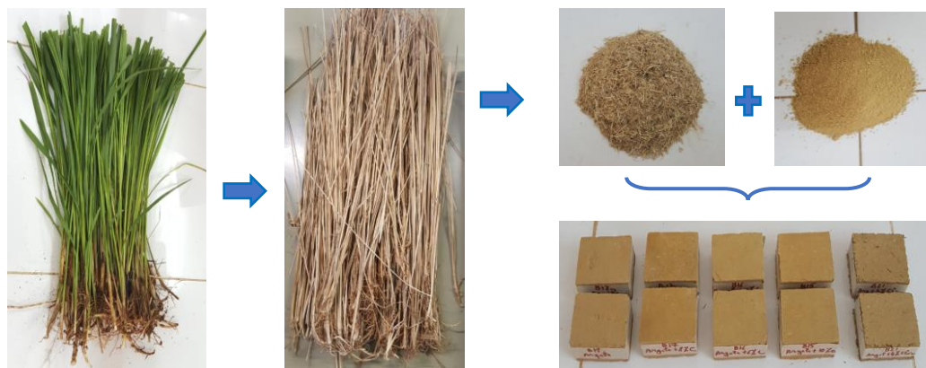
Figure 2 : Etapes de fabrication des échantillons
