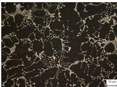
Figure III-4 : Microstructure de la nuance HSS A issue de la coulée centrifuge, après attaque profonde (dissolution de la matrice) montrant un réseau continu de carbures aux joints de grains, sans carbures massifs MC
