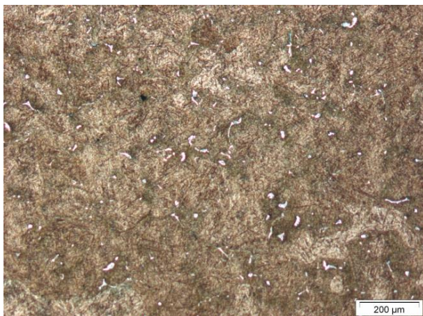
Figure IV-25 : Microstructure du semi-HSS 3 après essai de compression de l'austénite à 700°C, illustrant matrice bainitique, avec possible plages d'austénite résiduelle (austénite secondaire en lobules)
