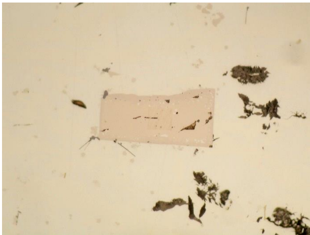
Figure II.3.1: NbC I massif et anguleux (Rose) et Graphite lamellaire en agrégats (HAlCl 2 ; profondeur de 0 à 10 mm dans le métal d'enveloppe (poli-miroir, état BCR)
