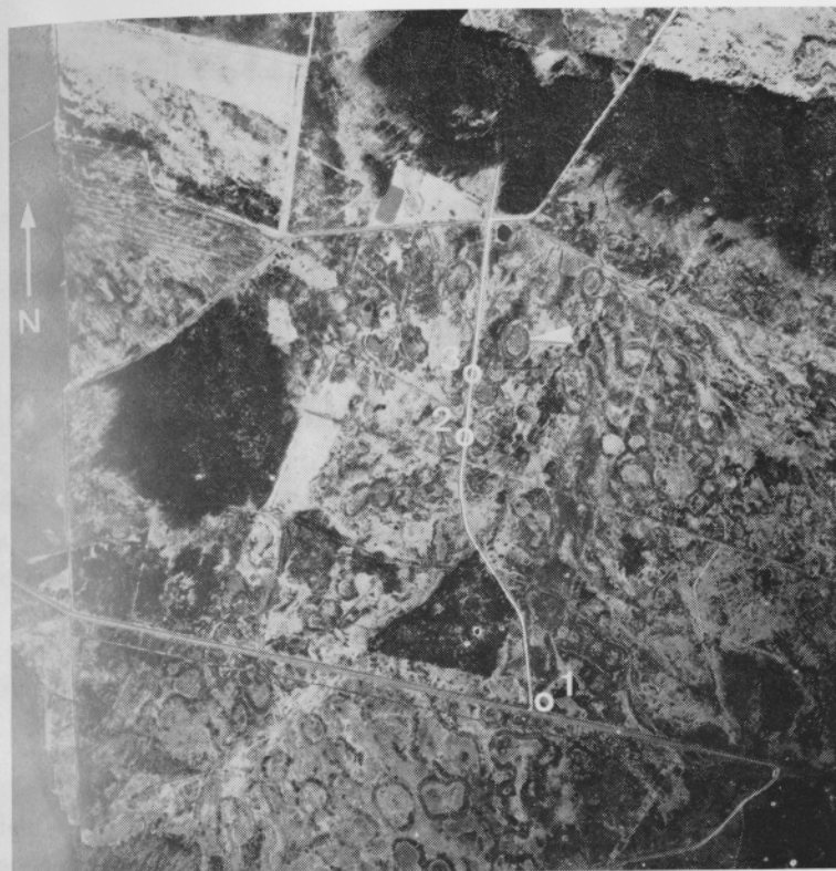
Figure 7. — Photo aérienne de la Fagne de la Brackvenn montrant par des cercles la localisation des sondages effectués. Profondeur atteinte : en 1, 23 m ; en 2, 25 m ; en 3, 12,50 m. La flèche indique la localisation de la coupe étudiée.
