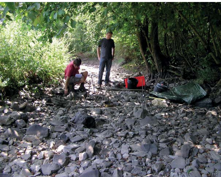
Figure 6 : Lit asséché de la Lembrée en aval de Ferrières dans le secteur à pertes karstiques diffuses. Analyse granulométrique du lit mineur et prélèvement des plus grosses scories transportées depuis le site d'injection.
