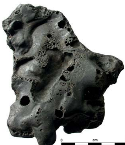
Figure 4 : scorie dense de forge d'affinage - Ruisseau de Cens (affluent de l'Ourthe occidentale)
