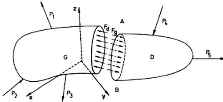
Ce principe montre que des forces apparaissent sur la surface d'une coupe qui isole un fragment d'une structure. D'un point de vue physique, ces forces internes représentent la transmission des charges entre les fragments à travers les coupes et correspondent à la capacité de la matière à transmettre des forces, grâce à sa cohésion.
