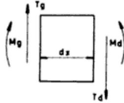
Ces sollicitations varient d'une section droite à l'autre, en fonction de l'abscisse  $x$  de la section. La représentation graphique de chacune de ces fonctions le long de l'axe de la poutre s'appelle diagramme de l'effort tranchant ou diagramme du moment de flexion.
