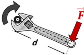
Schématiquement, on a  $moment = force \times distance$ . Lorsque les vecteurs  $\vec{F}$  et  $\vec{d}$  sont perpendiculaires, alors l'intensité du moment vaut simplement  $M = F \cdot d$ .
