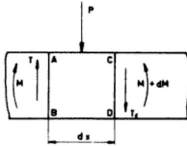
Si  $T$  désigne l'effort tranchant dans la section  $AB$  et  $T_1$  celui existant dans la section  $CD$ , l'équilibre de l'élément de poutre impose
