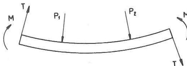
De ces conventions, on en déduit que le moment fléchissant est positif s'il tourne dans le sens des aiguilles d'une montre quand on l'évalue en fonction des forces à gauche et dans le sens contraire quand on l'évalue en fonction des forces à droite.
