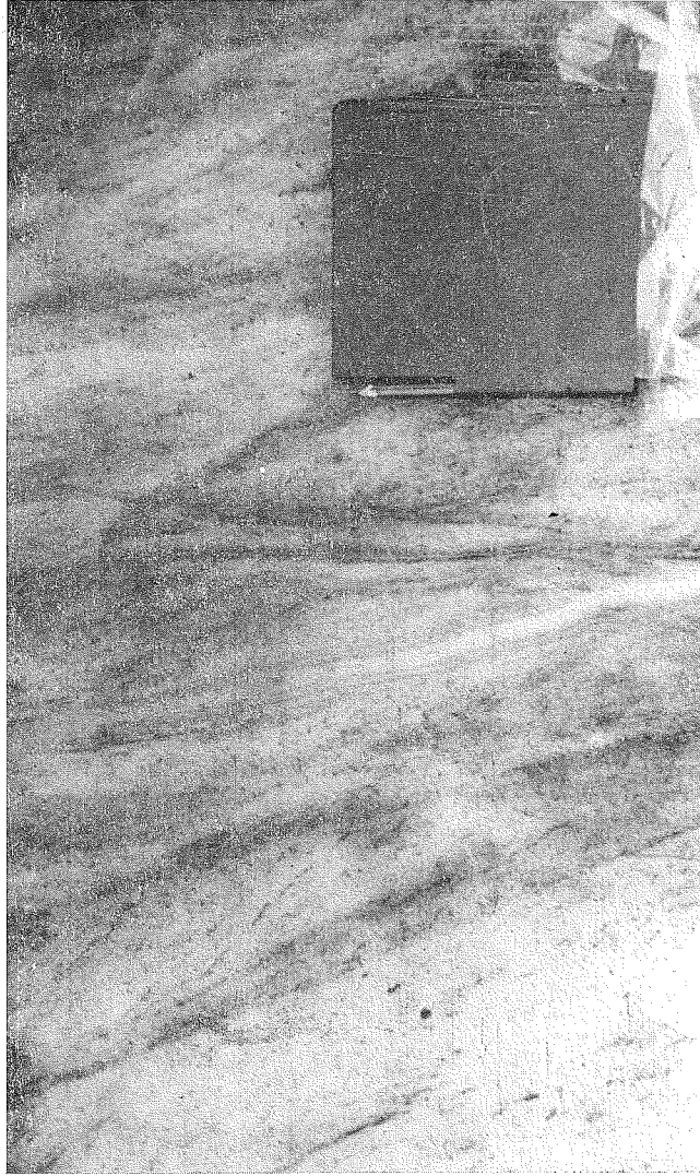
Photo 2. Coin de glace — Plusieurs zones d'accroissement annuel sont reconnaissables. Elles se recoupent mutuellement
