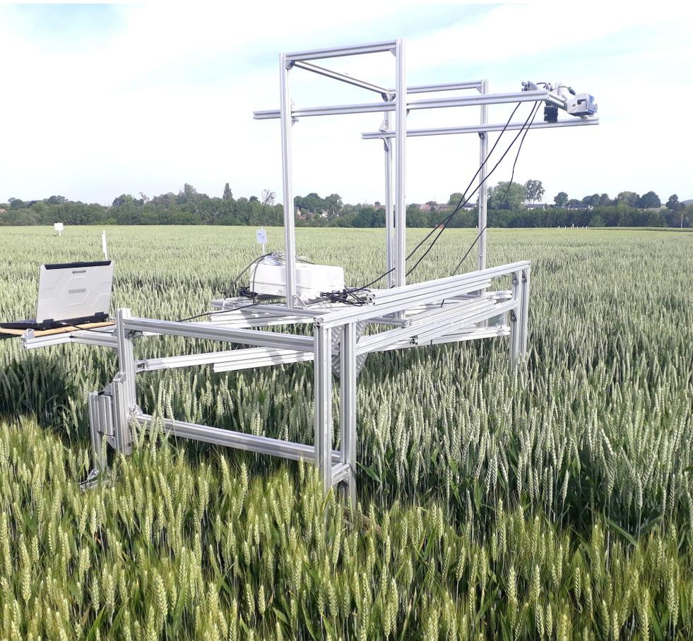
*Développement d'un système de mesure automatisé pour évaluer les variétés de froment d'hiver résistantes à différents stress*
