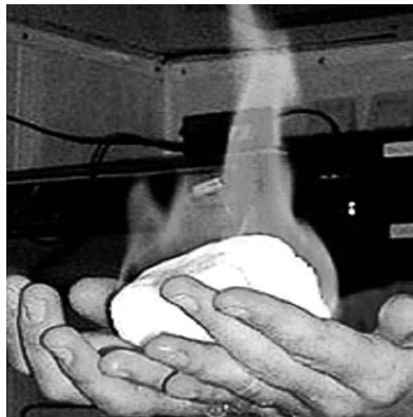
Figure 2. Les hydrates de méthane sont appelés familièrement la glace qui brûle. Sur cette photo, un bloc de méthane à la température ordinaire et à la pression atmosphérique se décompose en libérant le méthane et l'eau qui apparaît sur les mains tenant l'hydrate. Le méthane est, sur cette photo, en feu.
