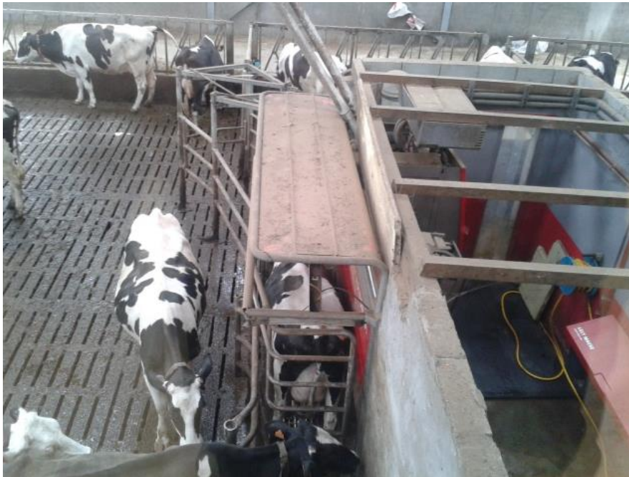
Figure 4 Aménagement du robot dans l'étable. Les vaches sont guidées par un système de barrières. Sur la droite, le bureau, où l'agriculteur consulte les rapports générés par le robot (Photo : Henri Luc Landais).
