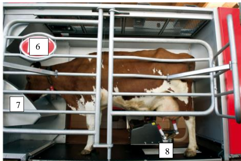
Figure 2 Unité de traite: Vue latérale montrant le positionnement de la vache dans l'unité de traite via des barrières [6], l'auge de distribution des concentrés [7] et la mise en place des gobelets trayeurs [8].
