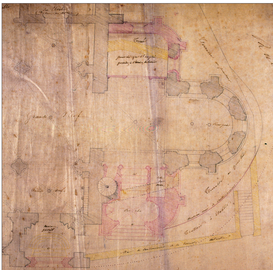
Fig. 6 : Plan des parties orientales de l'église avec emprise du portail projeté. La terrasse est visible en bas à droite. Plan de Jean-Charles Delsaux, probablement 1856. © Fabrique d'église de Sainte-Croix.
