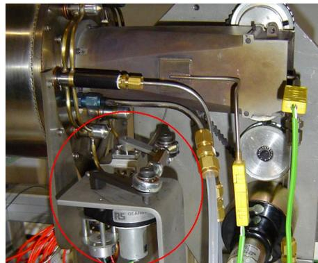
FIG. 3.11 – Système d'actuation de la vanne de carburant
