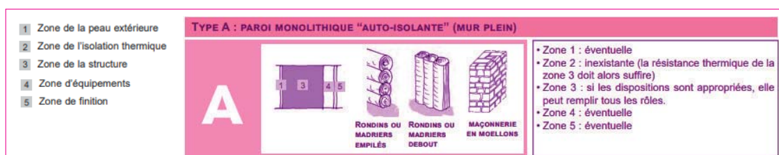
Fig. 11. Typologies de parois – type A : paroi monolithique « auto-isolante » (mur plein)
