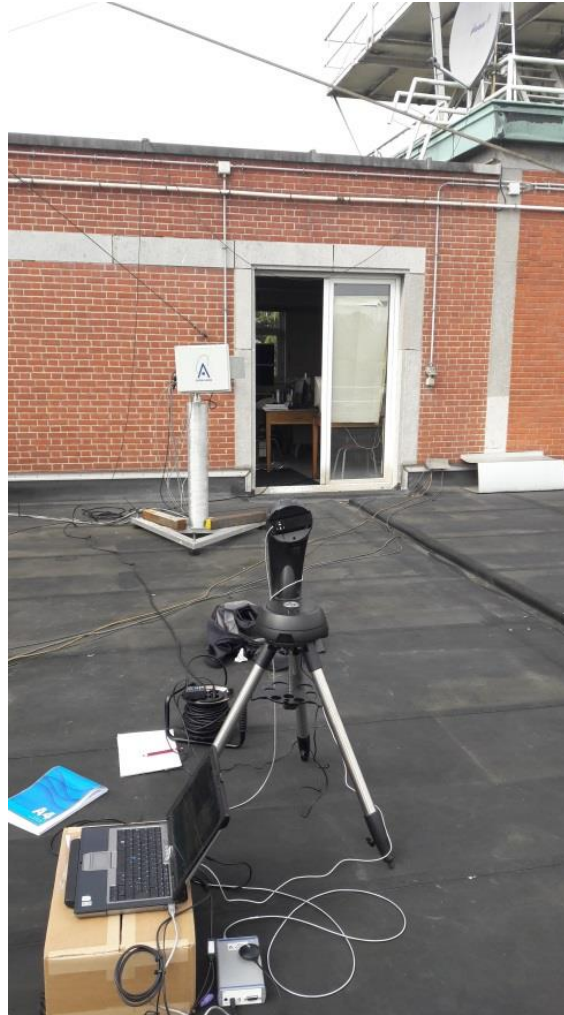
Pied du Télescope NEXSTAR 5 pour les mesures MaxDOAS avec une alimentation de 12,8v/1.5A.
