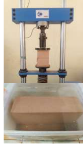
Le mélange de la terre et le liant innovant produit des briques comprimées de bonne résistance mécanique (haut) et à l'eau (bas).
