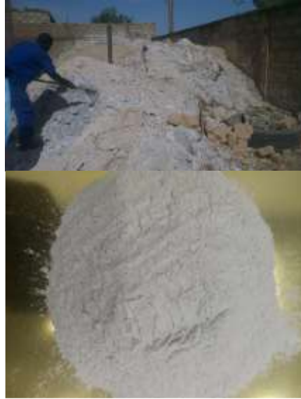
Le liant innovant est un déchet industriel (haut) et broyé en poudre fine (bas).
