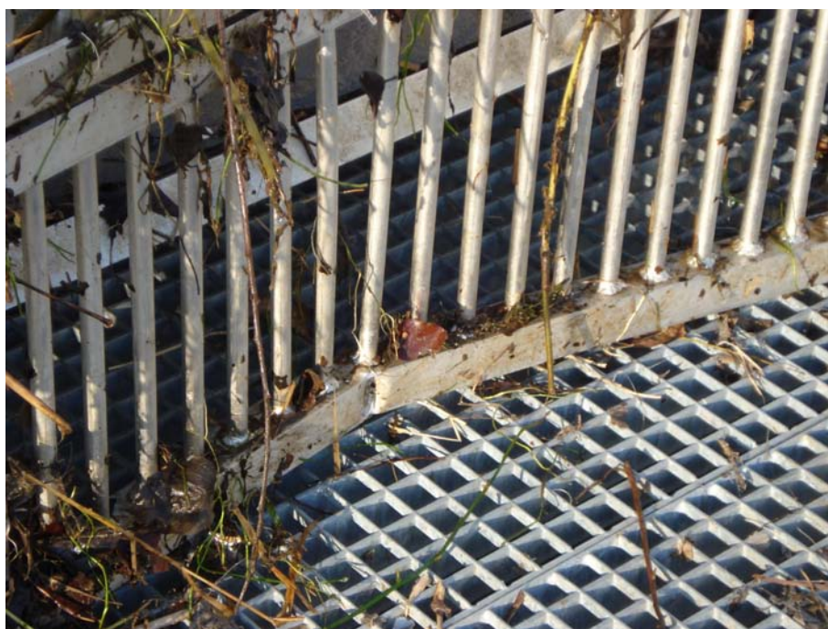
Figure 7. Déformations de la cage de capture causées par la pression de l'eau sur la couche de débris qui colmatent les barreaux en fin d'année.
