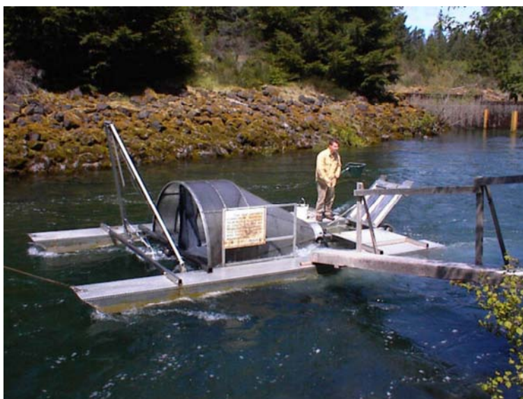
Figure 6a. Modèle de nasse rotative flottante utilisée pour échantillonner les saumoneaux et les autres poissons dévalants en rivière rapide et moyennement profonde.
