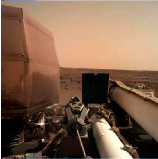
Autoportrait d'InSight réalisé peu après son arrivée avec la caméra IDC (Instrument Deployment Camera) fixée sur un bras robotique. (NASA/JPL-Caltech)
