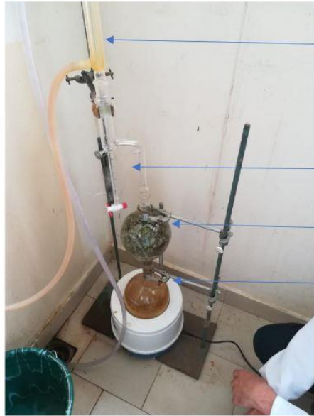
Image 2. Appareil d'extraction de type « Clevenger »
