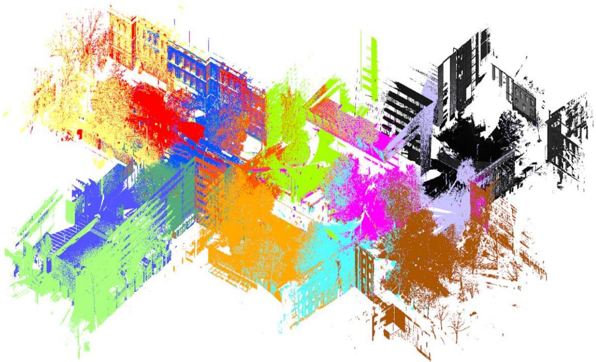
*Figure 2. 7 Nuage de points issu d'une consolidation avec un géo référencement direct des stations de scan, l'Université RWTH, Allemagne*
