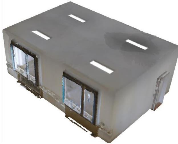
*Figure 2. 2 Un nuage de point 3D crée par lasergrammétrie*
