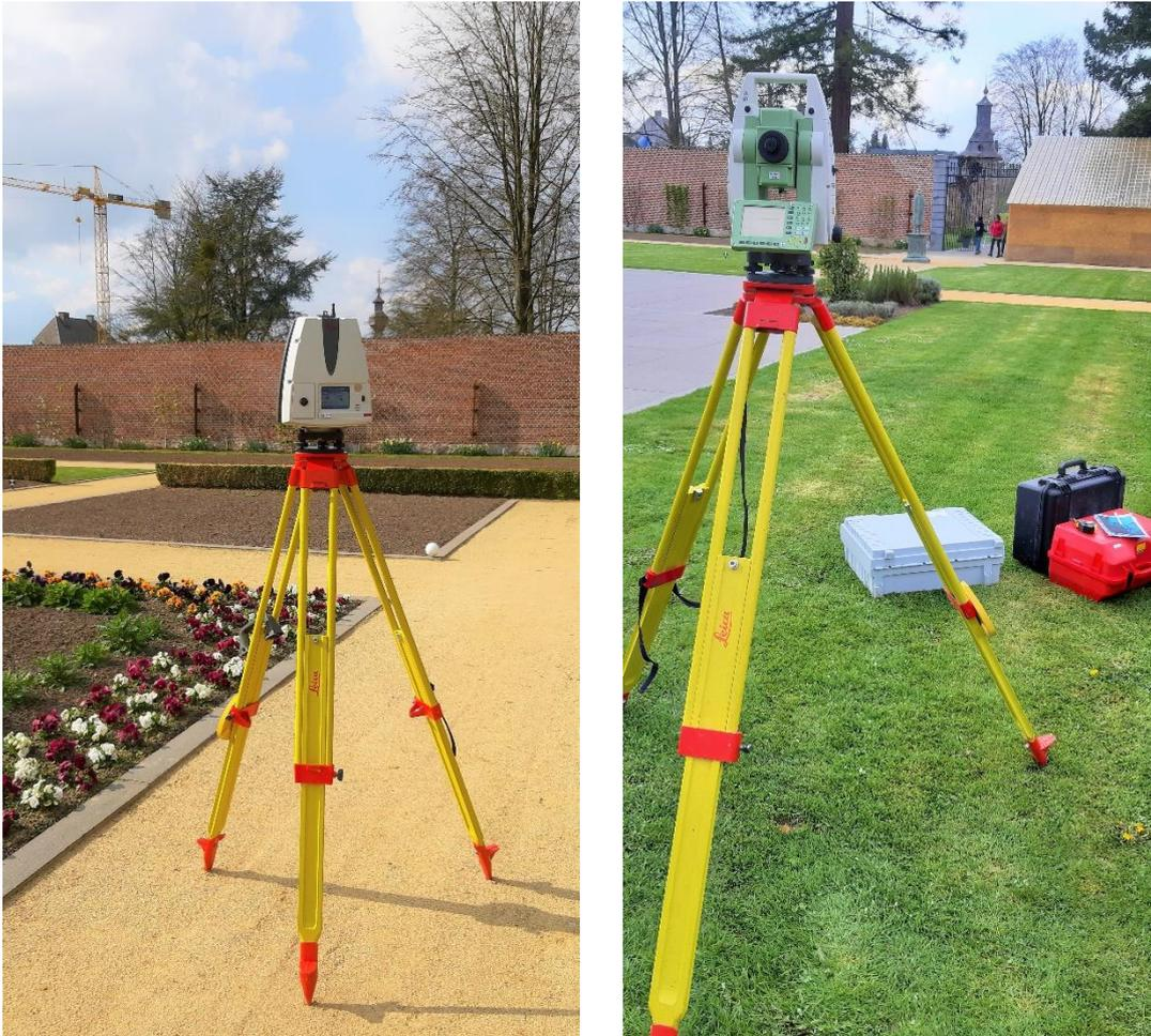
*Figure 3. 2 Scanner laser Leica P30 à gauche, et station totale à droite pour le levé*
