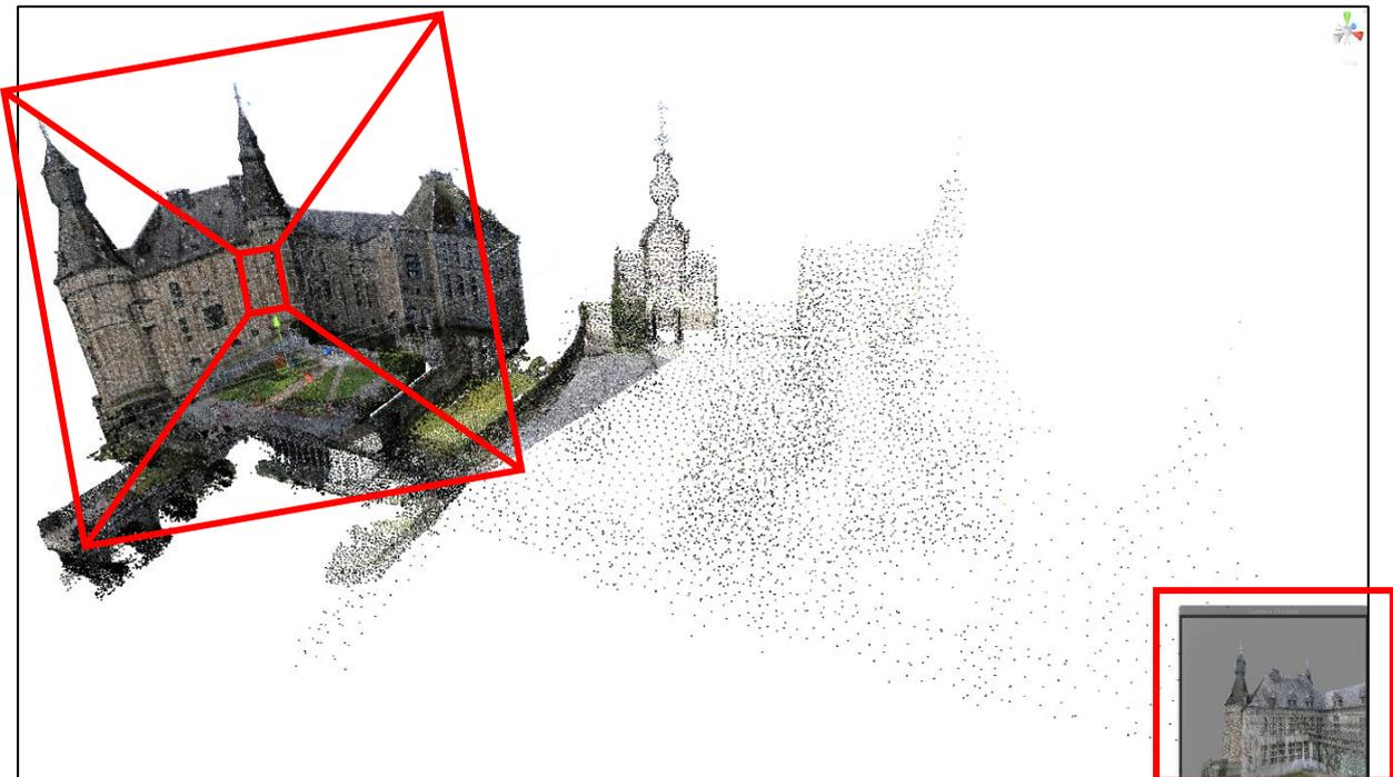
**Figure 4. 3** les nœuds en face de la caméra (en rouge) sont rendus plus en détails que ceux partiellement dans la vue, château de Jehay
