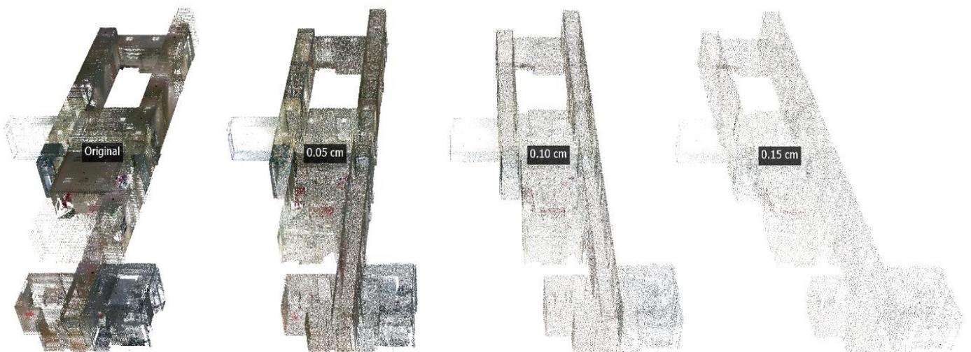
**Figure 2. 10** Nuage de points sous-échantillonné avec distances minimales ( $dm$ ) différentes. De gauche à droite, le nuage original (264 448 295 points),  $dm= 0.05cm$  (257 491),  $dm=0.10cm$  (65 296),  $dm= 0.15cm$  (29 229)
